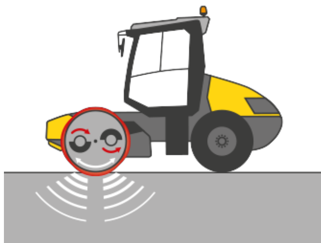
Type de compactage 2 : le mode oscillant pour un compactage de surface optimal.
