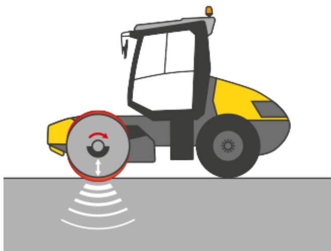
Type de compactage 1 : le mode vibrant pour une profondeur de compactage élevée.
